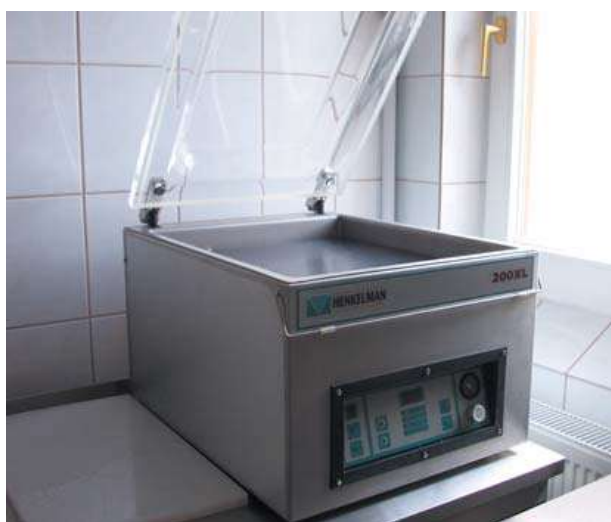
Εικόνα 8: Συσκευαστική μηχανή τροποποιημένης ατμόσφαιρας μικρής κλίμακας. Μετά τη συσκευασία το προϊόν είναι έτοιμο για ζύγιση και ετικέτα
