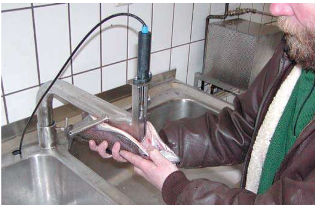
Εικόνα 2: Ένας απλός αλλά εξαιρετικά κατάλληλος πάγκος για καθαρισμό ψαριών (πάνω δεξιά). Λεπίδα για το κόψιμο της κοιλιάς με συσκευή εκκένωσης στερεωμένα κοντά στη βούρτσα τροχού για τον εσωτερικό καθαρισμό και εκσπλαχνισμό των ψαριών (πάνω αριστερά και κάτω).
