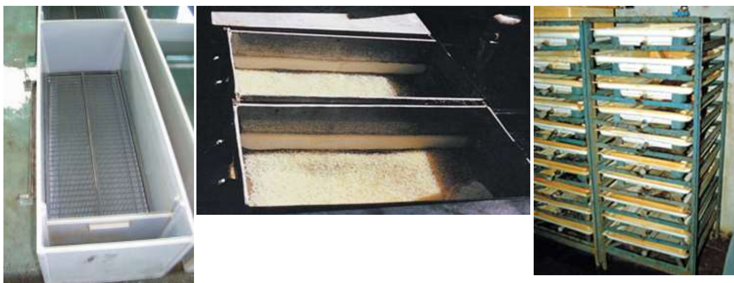
Εικόνα 8: Διαφορετικές συσκευές επώασης για αυγά πέστροφας. 1 Συσκευή Καλιφίνιας, 2 Δίσκος εκκολαπτηρίου Σαντφορντ και 3 κατακόρυφο εκκολαπτήριο με δίσκους
